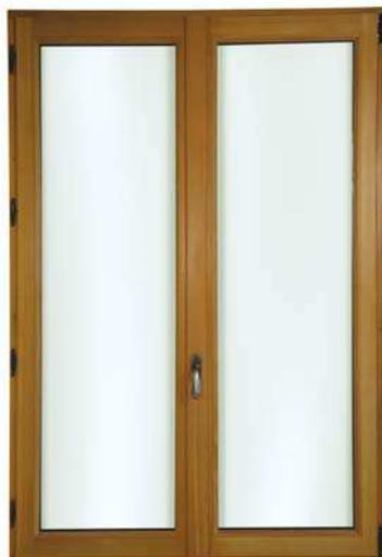
Dormant 63 mm assemblage mécanique vissé - Ouvrants 68 mm assemblage traditionnel à double enfourchement Jeu de 12 mm - Double joint d'étanchéité sur ouvrant - Mélèze - Traverse basse dormant avec nez d'appui 22 mm ou 65 mm
